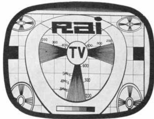
Fig. 6 - Linearità verticale mal regolata
